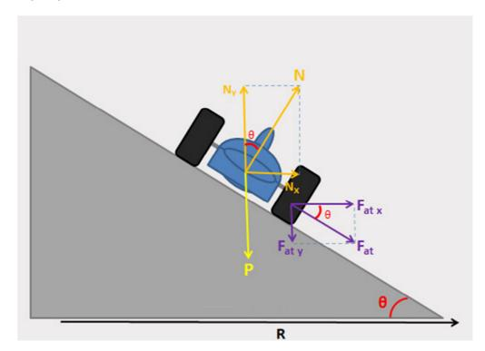
Um veículo tenta contornar uma curva plana e sobrelevada. Qual é a velocidade máxima de contorno considerando o ângulo de elevação da curva e o coeficiente de atrito estático dos pneus?
